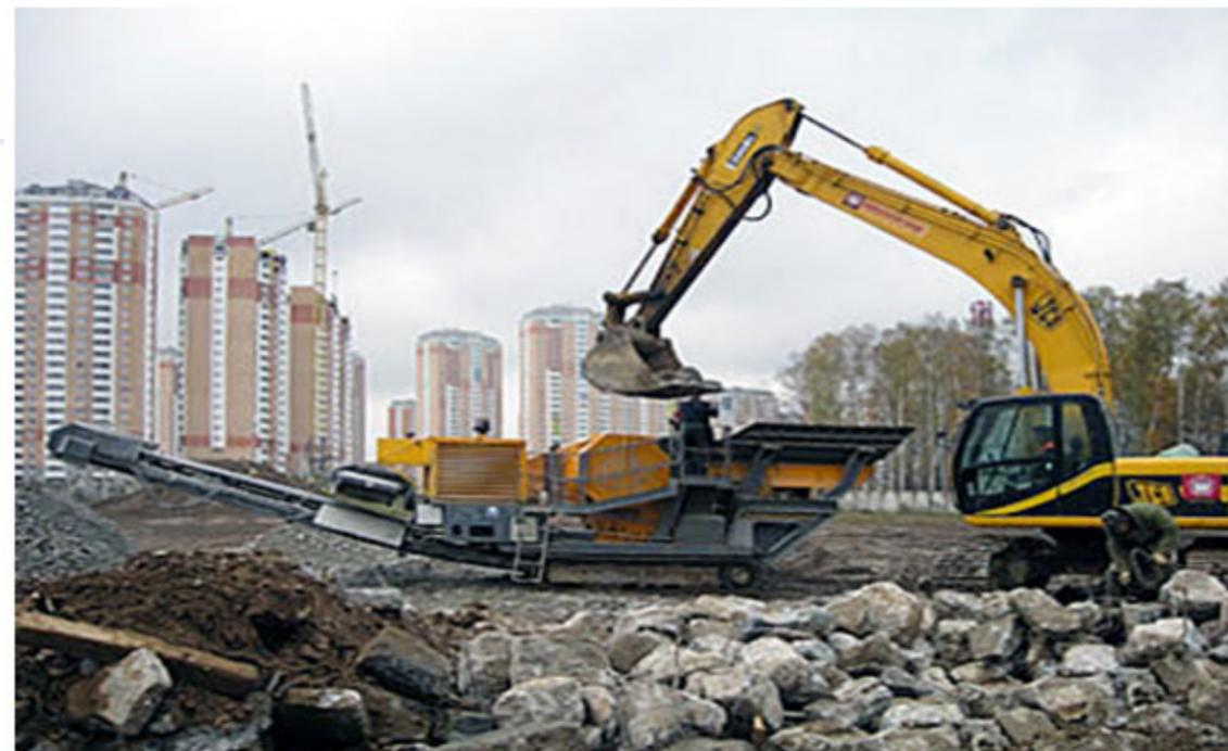
Soluciones Técnicas de la Trituración de los residuos de construcción — Planta portátil de Trituración
